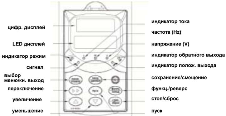
Рис. 4-2 Схема панели управления
