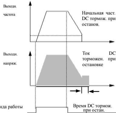
Рис.6-12 DC останов. и DC торможен.
