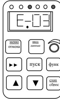
**Рис. 4-5 Отображение на дисплее состояния аварии**
