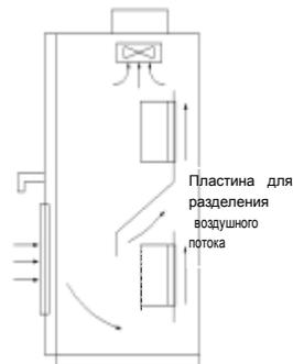
Рис.3-2 Монтаж нескольких инверторов
