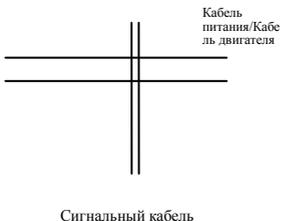
Рис. 3-16 Ортогональная прокладка кабеля
