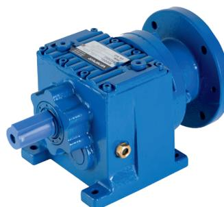
Соосно - цилиндрические редукторы **VRL** предназначены для применения в промышленных установках. Редукторы **VRL** являются модульной составляющей для мотор-редуктора. Соосная схема цилиндрического редуктора предусматривает расположение входного и выходного вала на одной оси. Основу редуктора составляют зубчатые передачи. Редукторы могут состоять из одной или нескольких ступеней.
